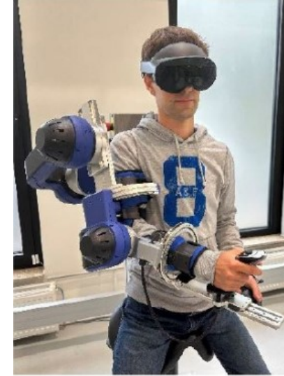
Démonstrateur X-ARM pour le retour haptique : encore un peu encombrant (source Space Applications Services NV/SA)
