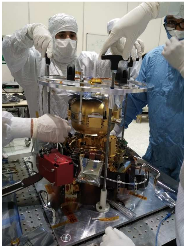
Intégration de la sphère dans l'instrument
