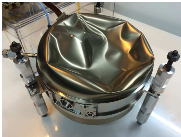
Flambage de "sphère" d'épaisseur héritée de Netlander.
